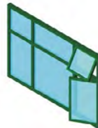
Acceptabele vervanging van kozijnen uit de bouwperiode vanaf 1920
