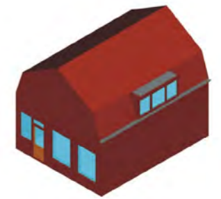
Dakkapel in mansardekap in onderste dakvlak plaatsen en aansluiten op knik
