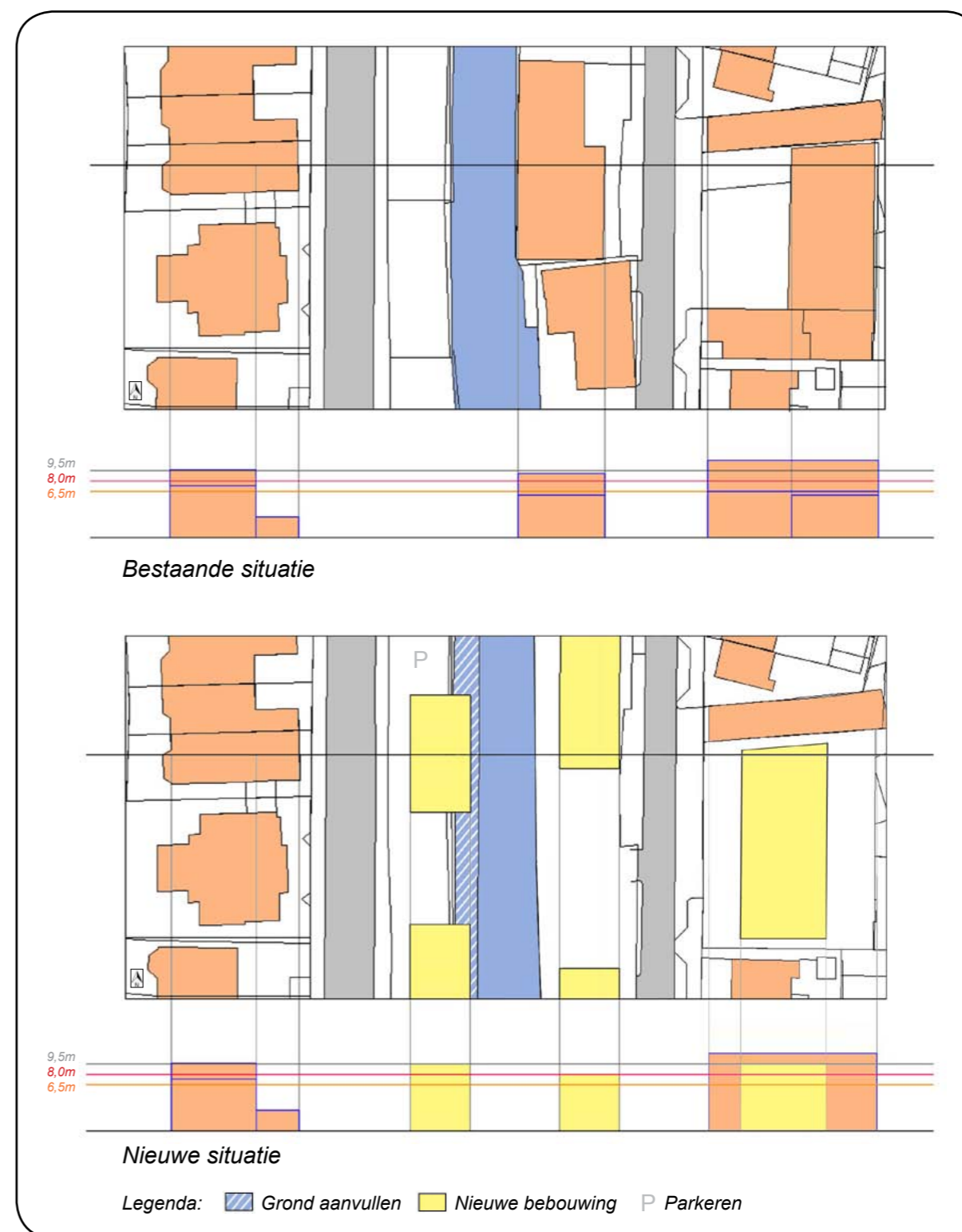
Schematische doorsneden (goot- en bouwhoogtes) gebied 5
